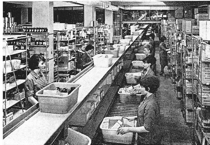
rectement vers la caisse. La caissière remettra en main propre, après contrôle, le colis au convoyeur.) A l'expédition, la marchandise est emballée, prête à être embarquée dans les camionnettes ; le bac vide remonte vers le début de la chaîne.
