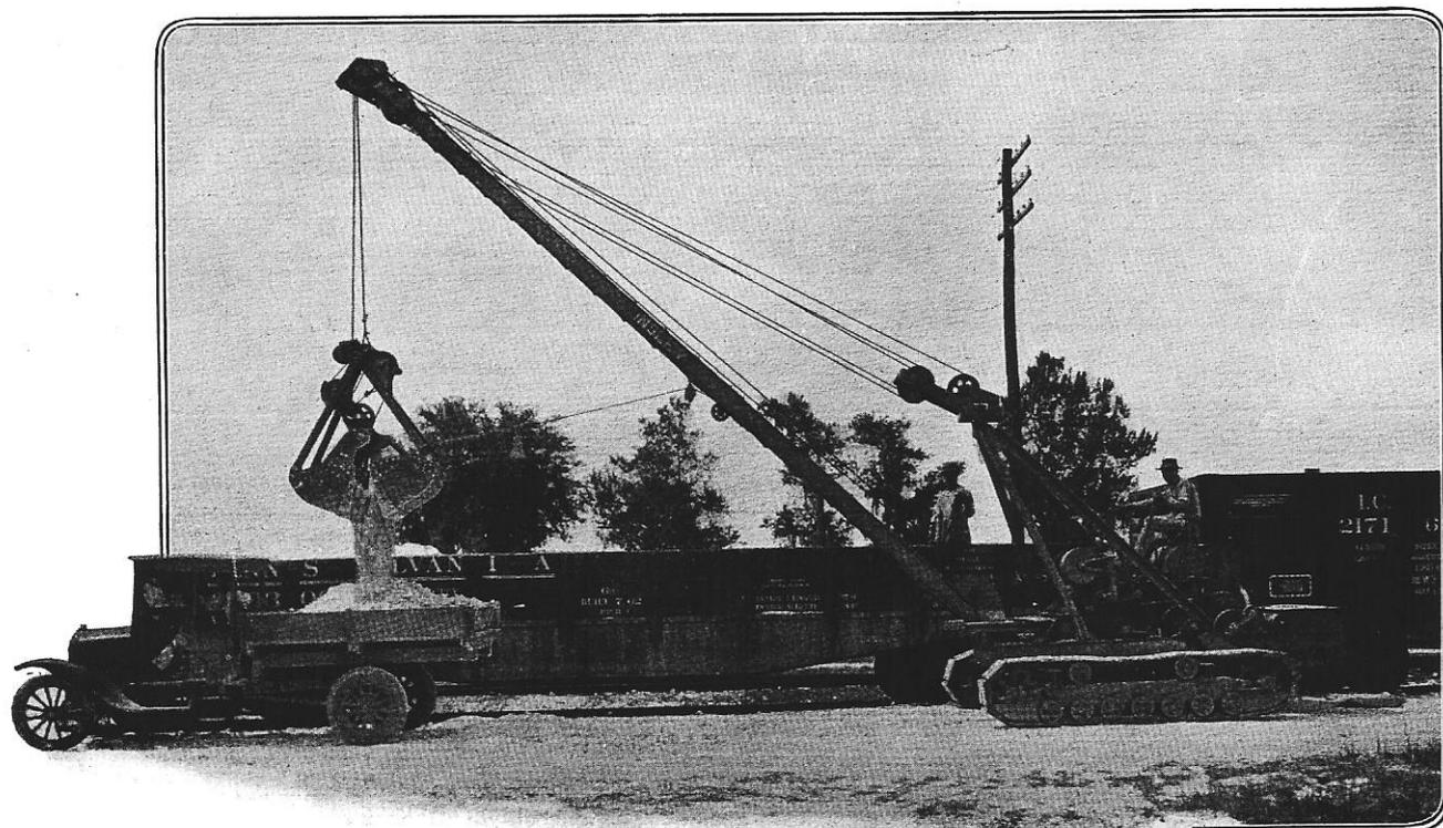
**Grue à grappin montée sur chenilles.** *Cet engin se déplace avec une aisance très grande. A noter que les Américains renoncent de plus en plus à la vapeur pour lui substituer le moteur électrique, ou le moteur à essence ou au mazout. On réalise de la sorte une économie notable dans l'emploi des grues et pelles à vapeur.*
